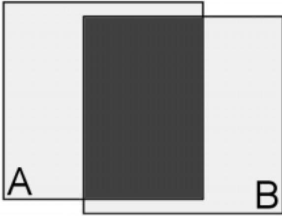
では、もう1枚の偏光板Cを用意して、AとBの間に斜めに挿入したら、3枚重なった部分の明るさはどうなると思いますか？
