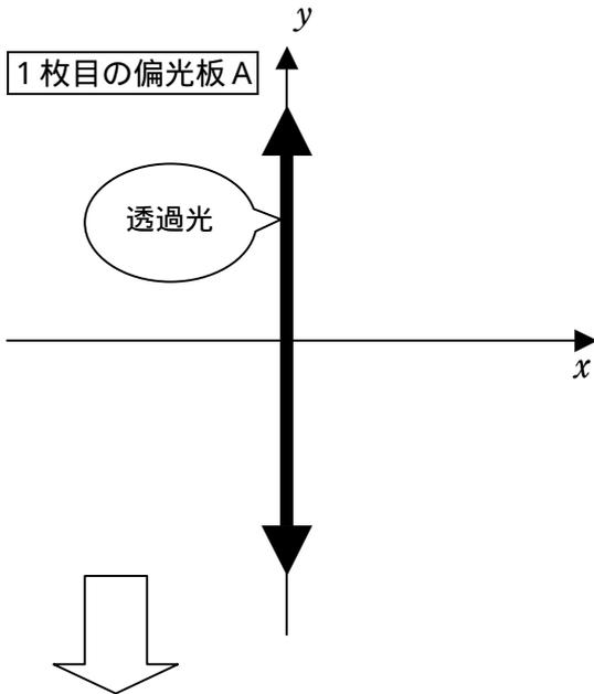
偏光板上に  $x, y$  軸を考えて、ここに入射した光の  $y$  成分だけが透過する、と考えます。
